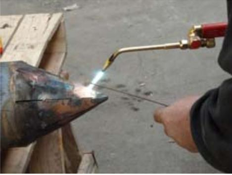
fabrication de l'enveloppe extérieure du capteur thermique en cuivre soudé
