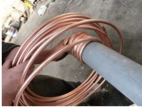
enroulement du système intérieur des tuyaux sur un tube pour permettre un contact maximal avec le compost chaud
