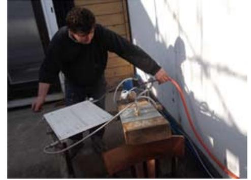
les tests préliminaires : alimentation du système avec de l'eau sous pression
