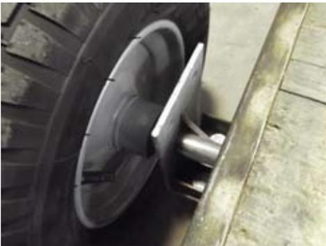
montage des roues sur la grande plateforme utilisant une tige filetée, des boulons et des cornières métalliques
